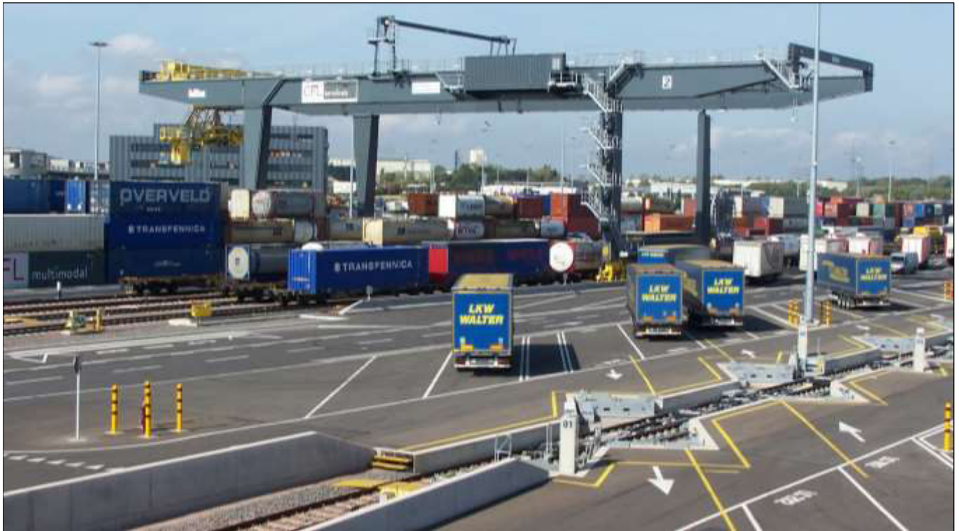
Portalkran im Intermodalen CFL Terminal in Luxemburg, im Vordergrund ein Gleis zur Horizontalverladung von Aufliegern (System Lohr); Foto: Gunther Ellwanger.
