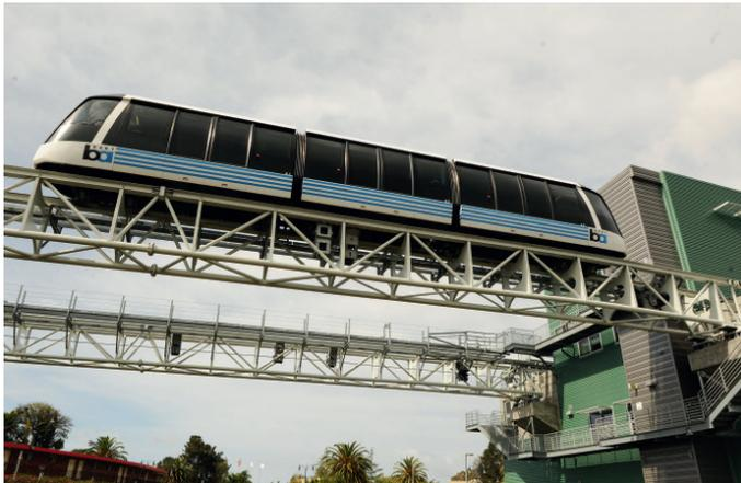
Abb. 10: Dieser People Mover verbindet den Flughafen in Oakland mit dem BART-System. Rechts im Bild die zentrale Antriebsstation mit integrierter Unterhaltsstätte.
