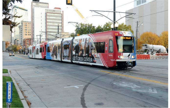
Abb. 8: Salt Lake City: Light Rail vom Typ Siemens S 70 in der Main Street. Es verkehren Kompositionen bis zu Vier-Wagen-Zügen.
