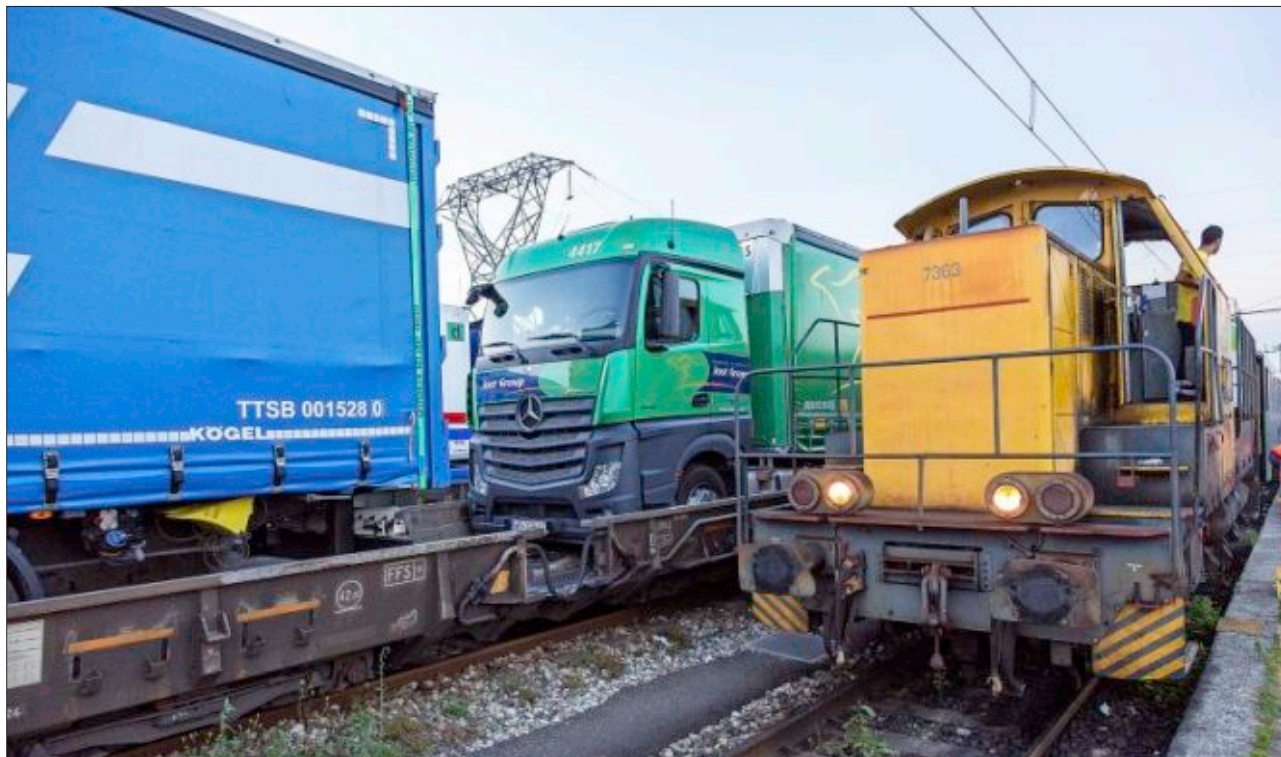
Statt auf der Straße auf der Schiene: Lkws, die die rollende Landstraße nutzen.
