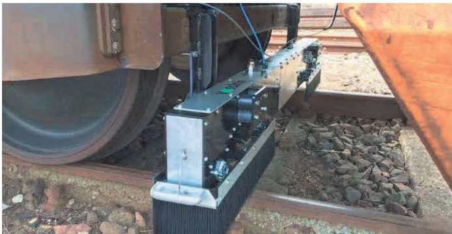
Die Messschiene zur Erfassung des Querprofils an einer HSG 2
