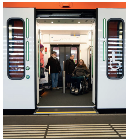
Abb. 2: Alle RBS-Züge sind niederflurig.
