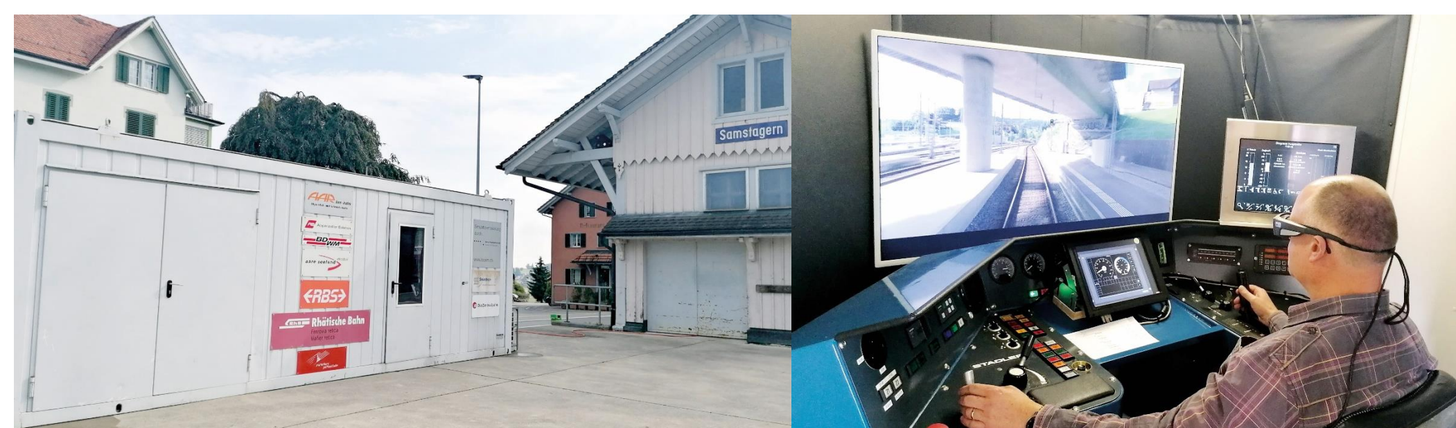
Abb. 1: Simulator von LOCSIM (li). Führerstand im Simulator von LOCSIM bei einer Fahrt mit Eyetracker (re).
