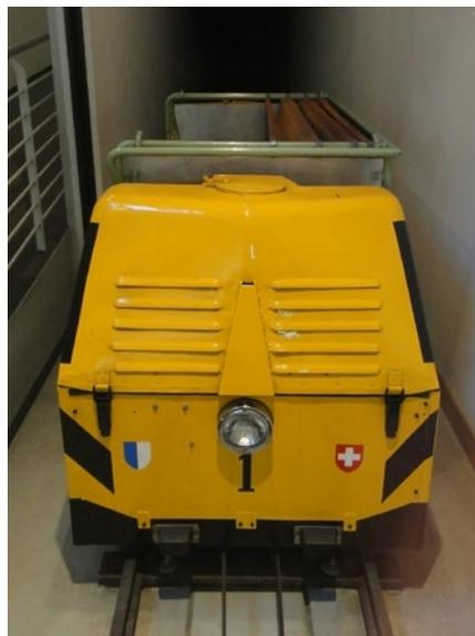
1: Elektromotorwagen der Post-U-Bahn in Zürich
