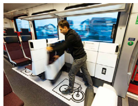
Abb. 7: Die Sitzgruppen werden an die Fahrzeugwand geschwenkt. Foto: SOB
